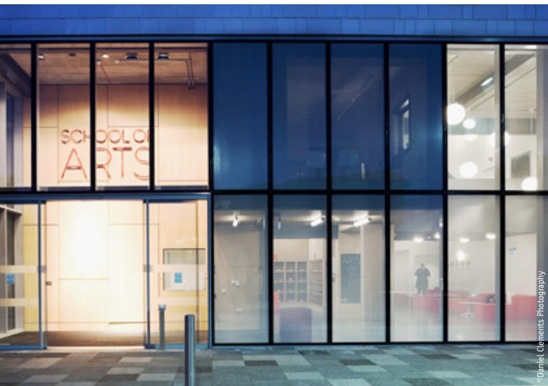
verbirgt sich hinter den Isolierglasscheiben, die dafür im Siebdruckverfahren mit einem umlaufenden schwarzen Rand versehen wurden. Gläser, die sich vor Wänden befinden, sind zudem auf der Rückseite vollflächig grau bedruckt. Ergänzend sorgen OKATHERM Funktionsgläser in den Fenstern der Südfassade für optimalen Sonnenschutz, verringerte Blendung, sowie gute Wärmedämmung. Mit dem in Kent eingesetzten 2-Scheiben-Aufbau werden U-Werte ab  $1,0 \text{ W/m}^2\text{K}$  erreicht. Dem von
