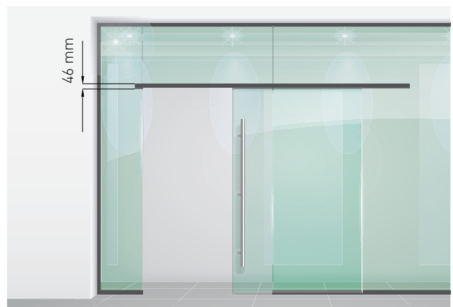
Schiebetürbeschlag und Zarge haben die gleiche Ansichtsbreite
